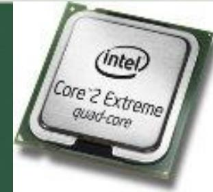
**Центральный процессор** – исполнитель машинных инструкций, часть аппаратного обеспечения компьютера или программируемого логического контроллера, отвечающий за выполнение операций, заданных программами.
