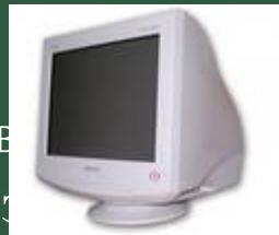
Монитор является универсальным устройством в информационной системе. В настольных компьютерах до сих пор используются **мониторы на электронно-лучевой трубке**. Но такие мониторы могут являться источником вредных для человека излучения.
