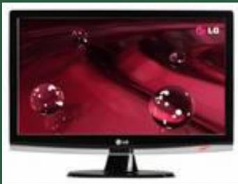
*TFT монитор* (англ. – тонкоплёночный) – это одна из разновидностей жидкокристаллического дисплея, в котором используется активная матрица, управляемая тонкоплёночными транзисторами.
