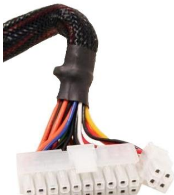
Коннектор блока питания (стандарт ATX v2)
