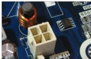
Разъем для подачи питания на процессор
