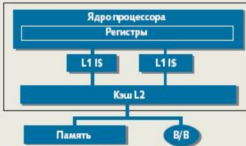
в) Многоядерная архитектура с общей кэш-памятью
