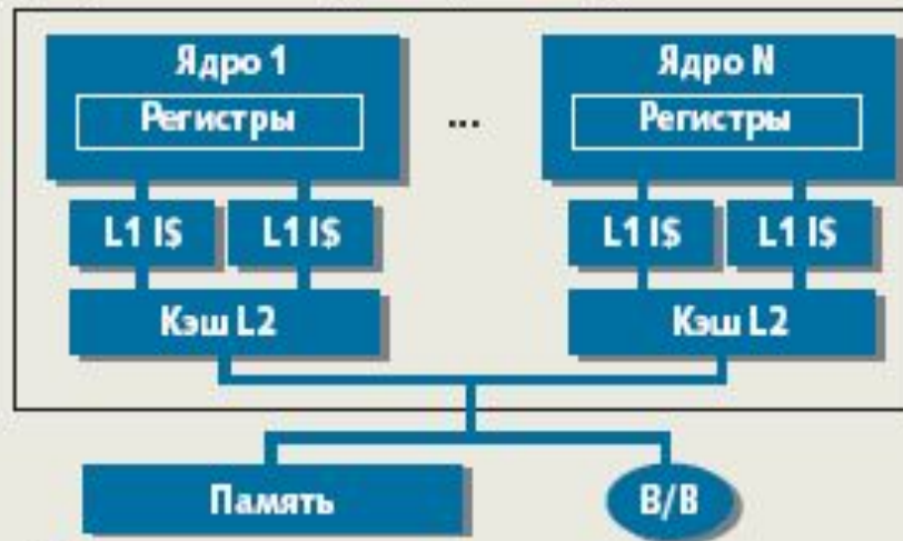
г) Многопоточная многоядерная архитектура с общей кэш-памятью
