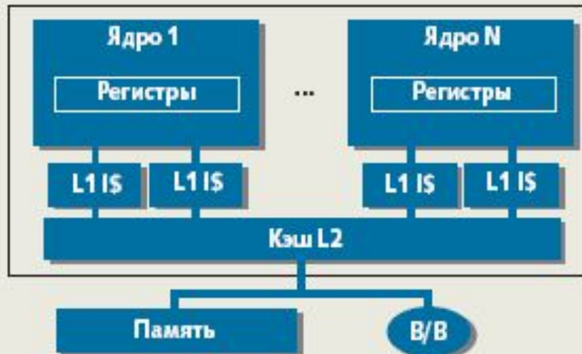
в) Многоядерная архитектура с общей кэш-памятью
