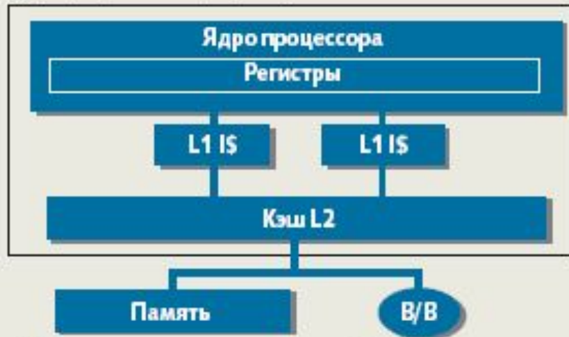
в) Многоядерная архитектура с общей кэш-памятью
