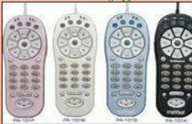
Японская компания Mevael представила компьютерную мышь Keiboard необычной конструкции, выполненной в виде пульта дистанционного управления или мобильного телефона. Благодаря необычной форме, на "мыши" имеется полный набор клавиш, что дает возможность набирать небольшие тексты одной рукой.
