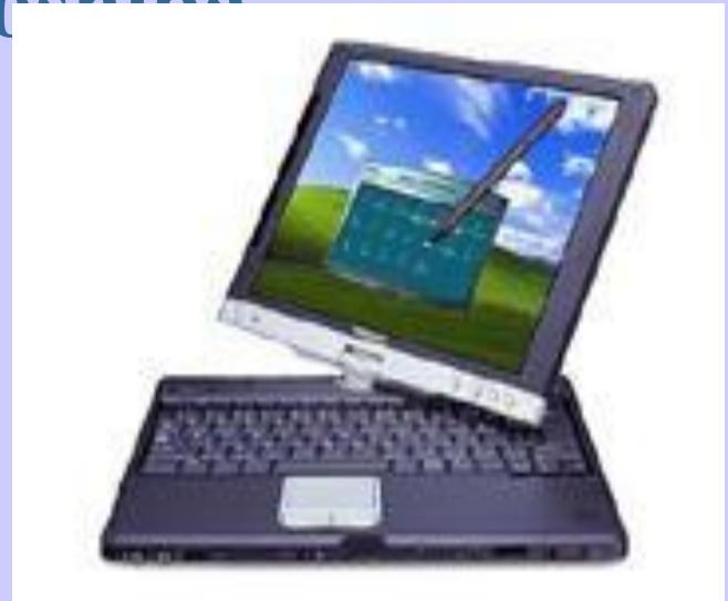
ПК выполнен на интегрированном чипсете Trident Cyber ALADDiN-T (видеопамять 16 Мб), оборудован 12,1-дюймовым XGA ЖК экраном с возможностью вращения на 180°.
