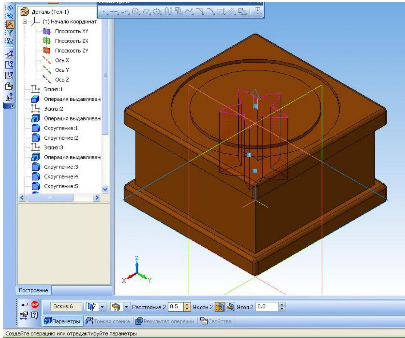
Вырезаем выдавливанием получившийся узор на глубину 0.5мм, нажимаем кнопку создать объект.
