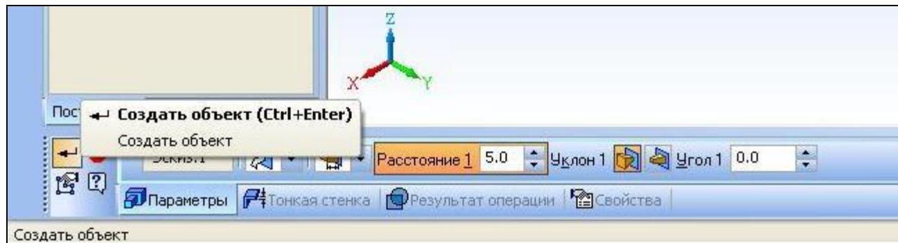
Чтобы продолжить работу, выделяем верхнюю грань, она становится зеленой, затем опять переходим в режим эскиз, и рисуем квадрат 50мм, после чего повторяем операцию выдавливания, но уже на расстояние 20 – это средняя часть коробочки. Так же выдавливаем и верхнюю крышку.
