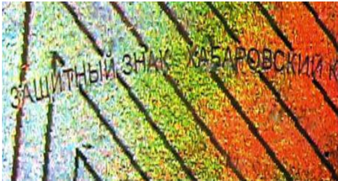
Микротекст на голографической наклейке (размер шрифта - 0,1 мм).
