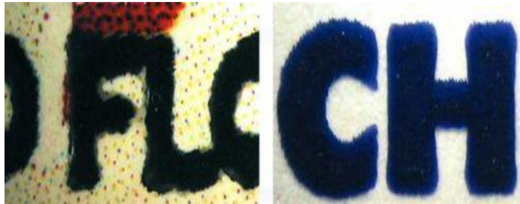
Рельефные изображения, полученные разными способами: — термография; — фазовый (твердочернильный) принтер.
