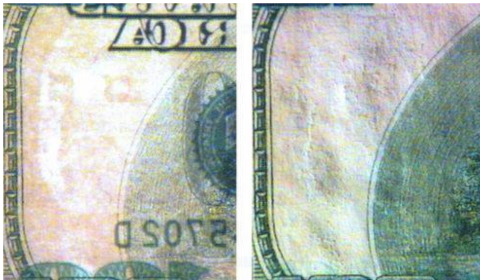
Имитация водяного знака механическим выскабливанием: а - вид на просвет; б - в косопадающем освещении.
