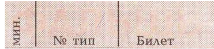
«Проявление» скрытого изображения на скопированном документе.
