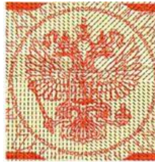
Позитивный микротекст на акцизной марке «Табачные изделия (РОССИЯ)».
