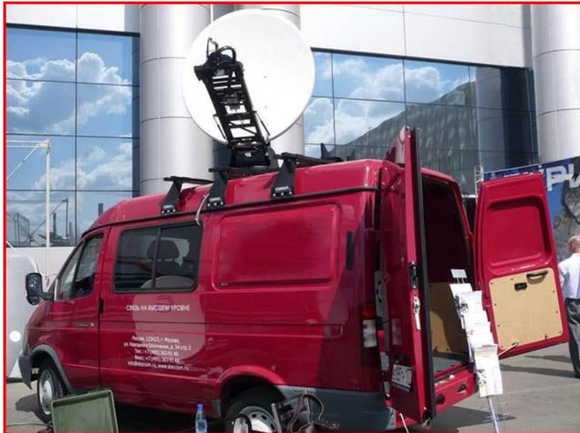
Опытный образец мобильной спутниковой станции с автоматическим наведением и сопровождением космического аппарата связи
