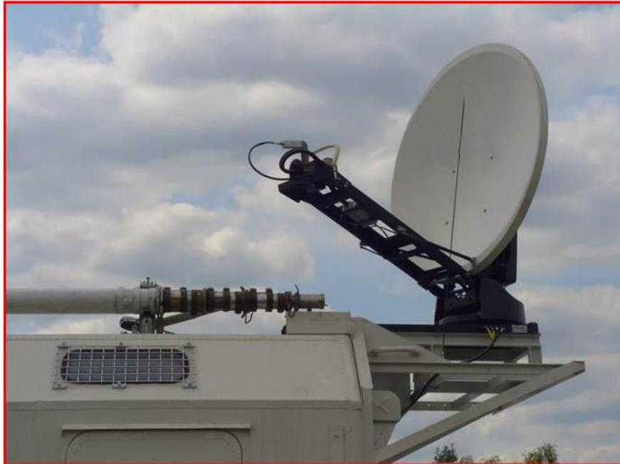
Спутниковая антенна  $\varnothing$  1.2 м с системой автоматического наведения и сопровождения
