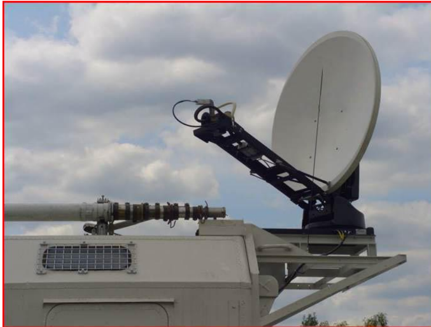
Спутниковая антенна Ø 1.2 м с системой автоматического наведения и сопровождения
