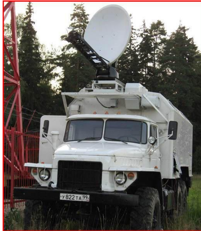
Опытно-рабочий образец мобильного спутникового комплекса связи на базе полноприводного автомобиля «Урал»
