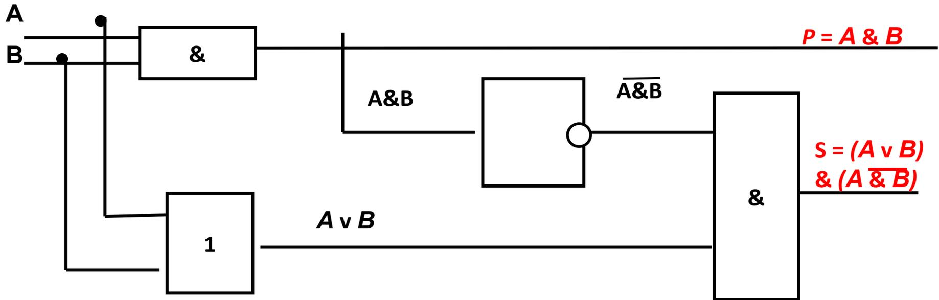
Данная схема называется **полусумматором**, так как реализует суммирование одноразрядных двоичных чисел без учёта переноса из младшего разряда
