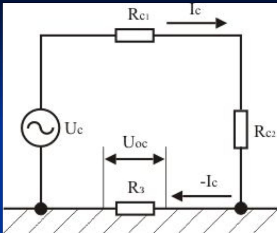
Утечка информации за счет падения напряжения на сопротивлении заземляющего устройства.
