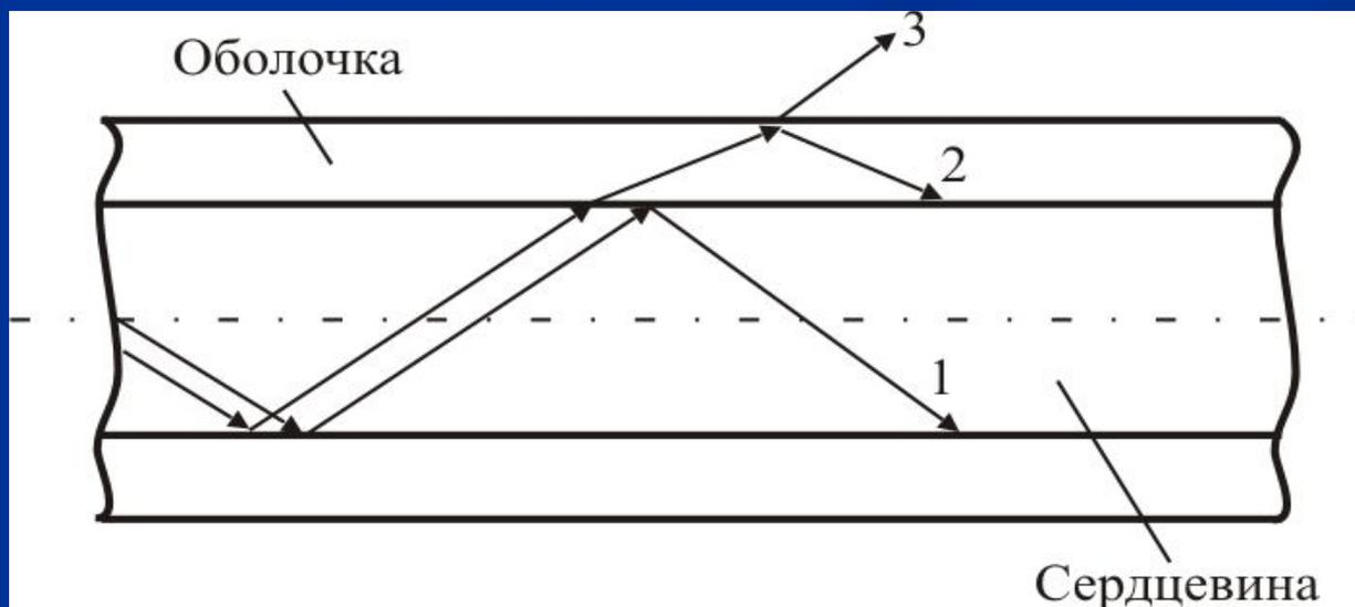
В прямолинейных световодах излучение в окружающую среду незначительно. Однако в местах изгибов волноводов интенсивность излучения в оболочку или воздух увеличивается, и тем больше, чем сильнее эти изгибы. Интенсивность излучения в окружающее пространство увеличивается и при повреждении оболочки световода.
