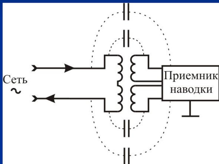
Вследствие этого в приемнике наводки индуцируются равные по величине обратные по знаку напряжения. Поэтому симметрично распространяющаяся наводка не может проникнуть в высокочастотную часть приемника наводки.
