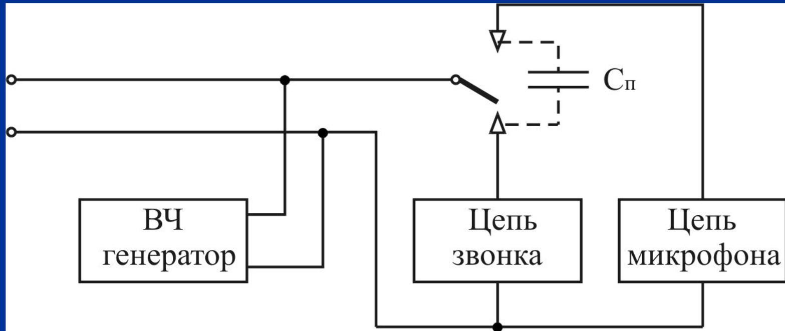
Принцип реализации высокочастотного навязывания в телефонном аппарате
