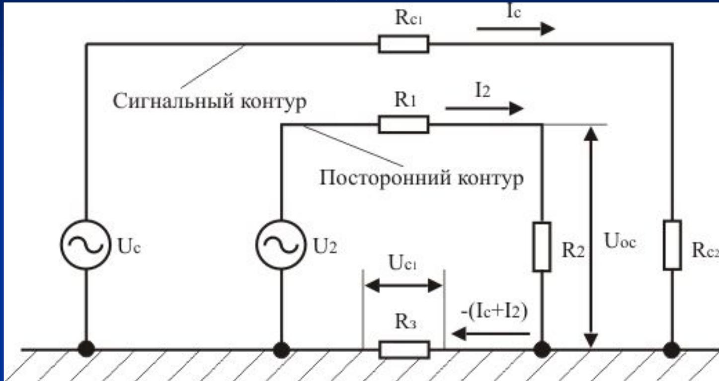
В этом случае для двух различных контуров — сигнального и постороннего — общая земля является обратным проводом с эквивалентным сопротивлением  $R_3$ .
