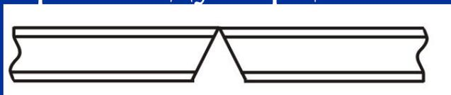
— непараллельность торцевых поверхностей волокон
