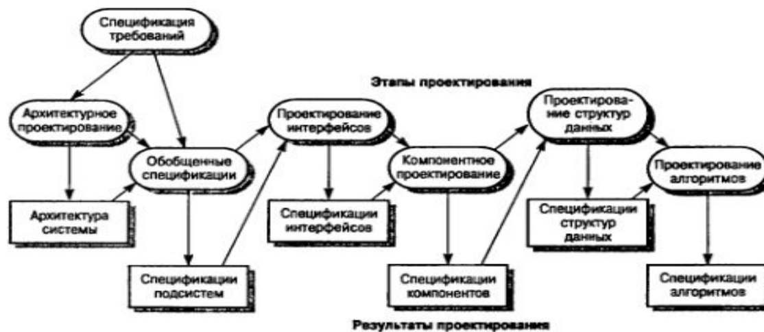
Рис. 3.9. Обобщенная схема процесса проектирования
