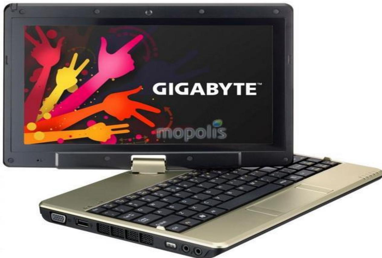
*Аппарат является трансформером – его экран может разворачиваться на шарнире, и за счет этого он может работать в двух режимах.*
