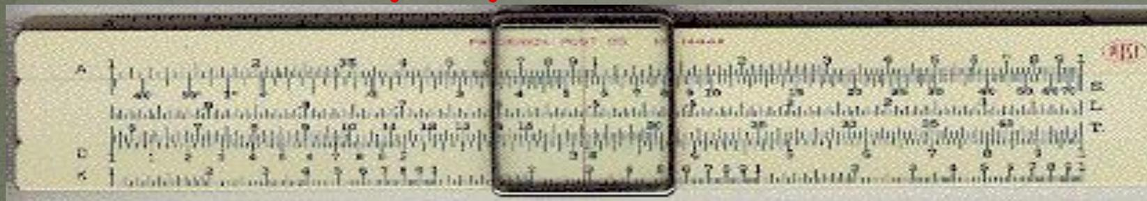
Англичанин Р. Биссакар, а в 1657 году - независимо от него - С. Патридж разработали прямоугольную логарифмическую линейку, конструкция которой в основном сохранилась до наших дней. Это простое на первый взгляд устройство достаточно хорошо продумано и позволяет производить сложные вычисления. Эта линейка и по сей день находится на вооружении в украинской армии, и ее использование аргументируется тем, что в случае ядерного взрыва все электрические устройства выйдут из строя.
