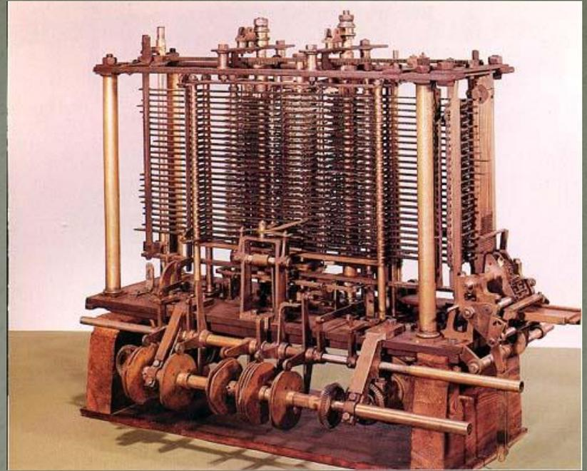
12 лет Чарльз Бэббидж разрабатывал механический прототип первых ЭВМ. Его вычислительная машина должна была выполнять вычисления по программе, задаваемой с помощью перфокарт. Результаты вычислений планировалось выдавать на печать или на перфокарты. К сожалению, технологии того времени не позволили Бэббиджу полностью воплотить идею создания аналитической машины.
