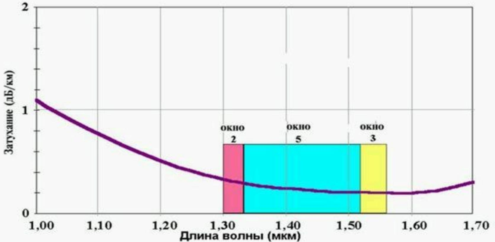
**Зависимость коэффициента затухания от длины волны одномодового оптического волокна**
