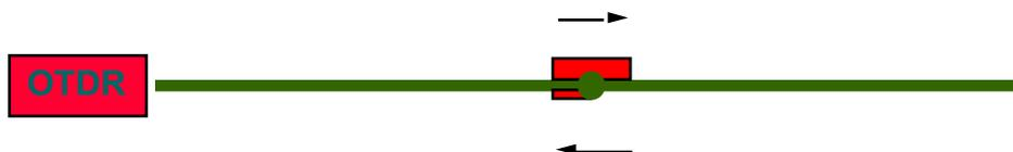
Отраженный импульс принимается OTDR.
