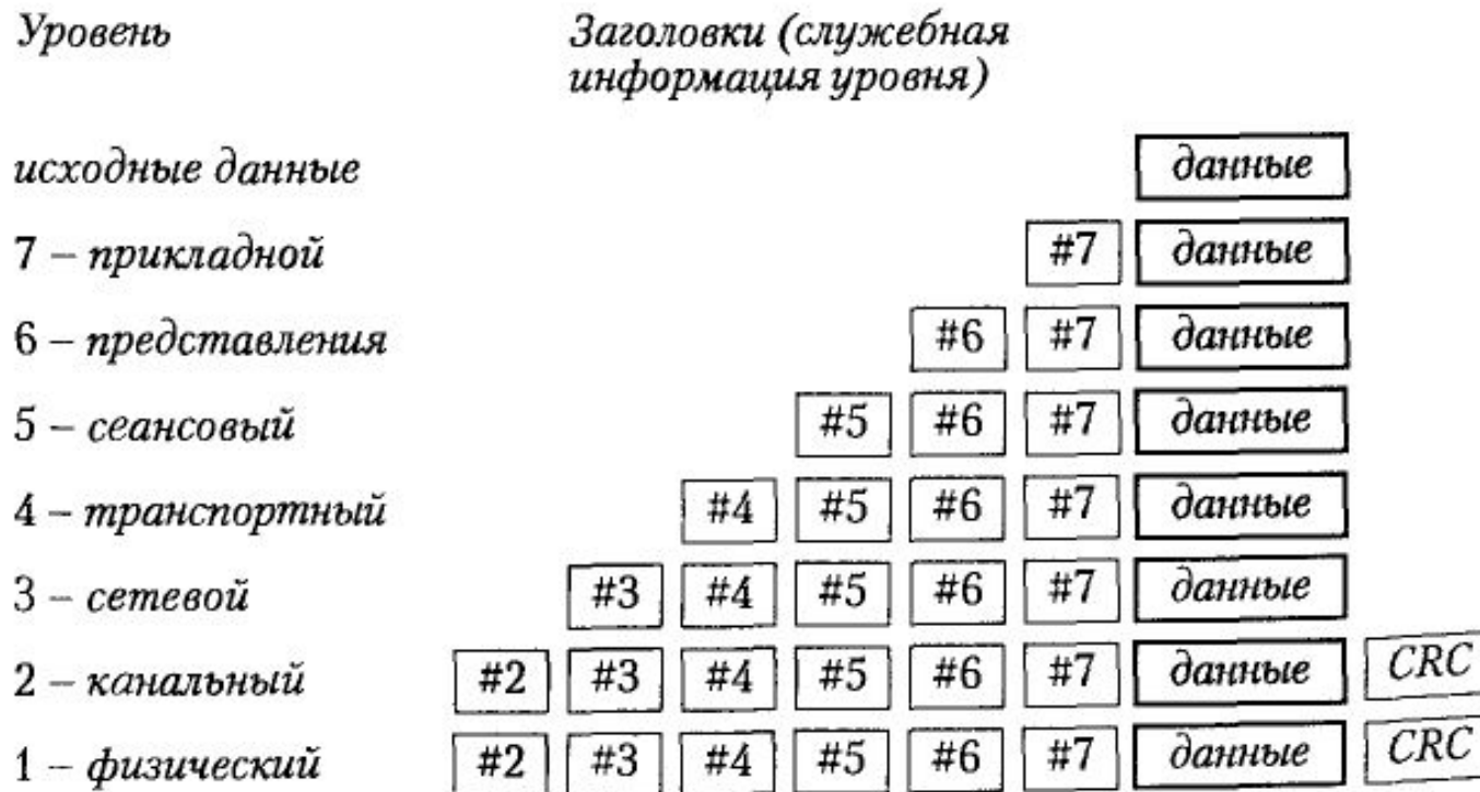
Рис. 7. Общая схема передачи информации между уровнями
