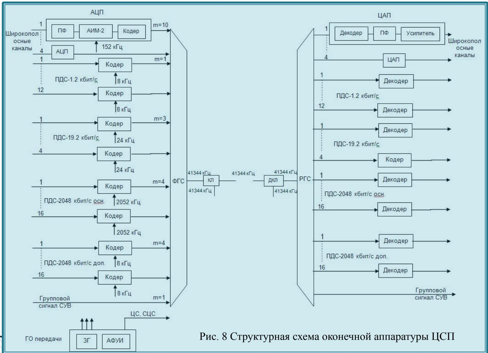
Рис. 8 Структурная схема оконечной аппаратуры ЦСП
