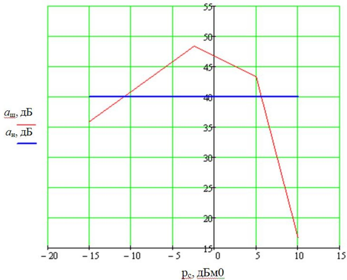
Рис. 2. График зависимости помехозащитности от уровня сигнала  $a_{ш}(p)$
