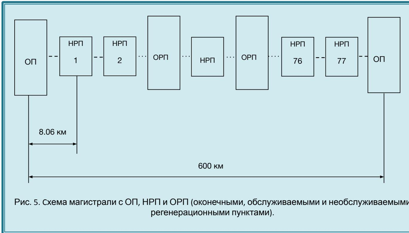
Рис. 5. Схема магистрали с ОП, НРП и ОРП (оконечными, обслуживаемыми и необслуживаемыми регенерационными пунктами).
