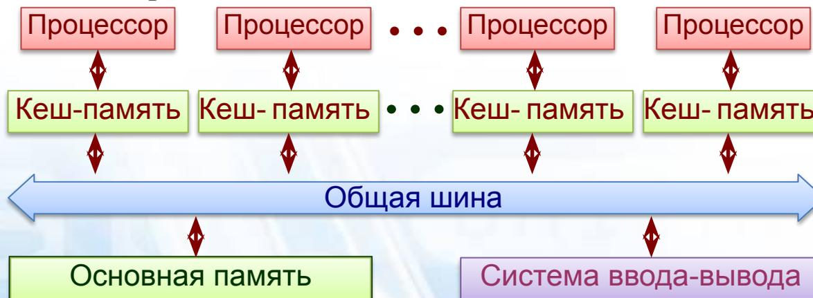
Физический интерфейс, логика адресации, арбитража и распределения времени в общей шине остаются такими же, как в однопроцессорной машине.
