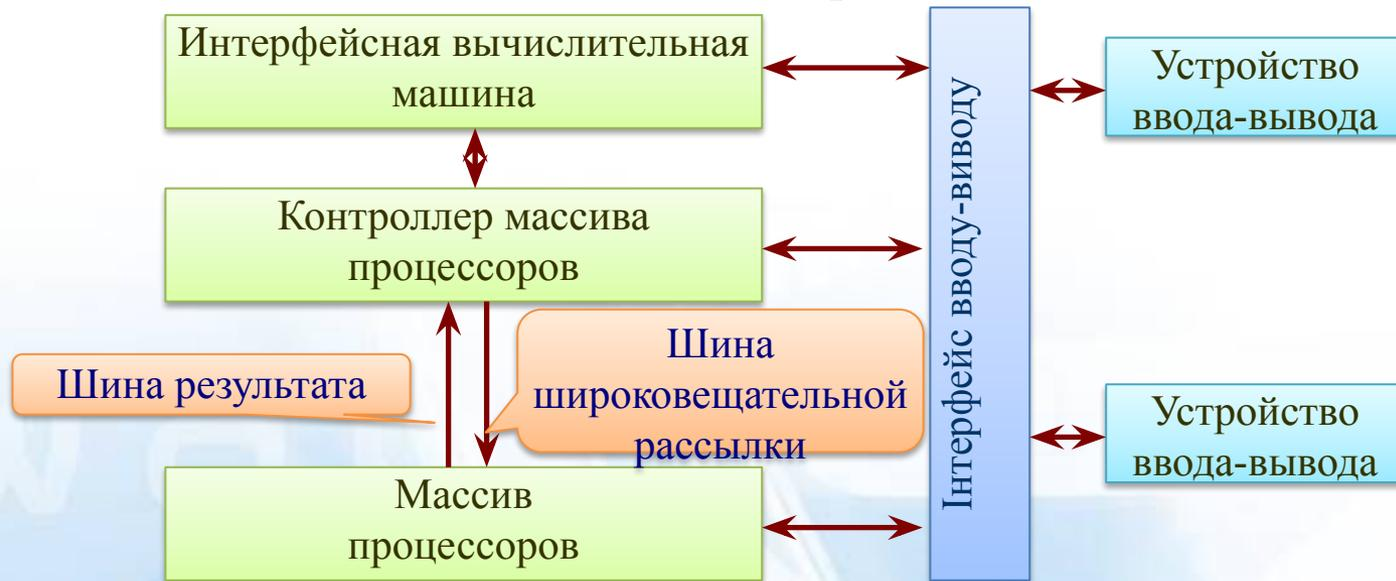
**Массив процессоров** – выполняет параллельную обработку элементов данных. Для хранения множественного набора данных в состав массива процессоров должно входить множество модулей памяти. Также в составе массива процессоров нужно реализовать сеть взаимосвязей как между процессорами, так и между процессорами и модулями памяти.
