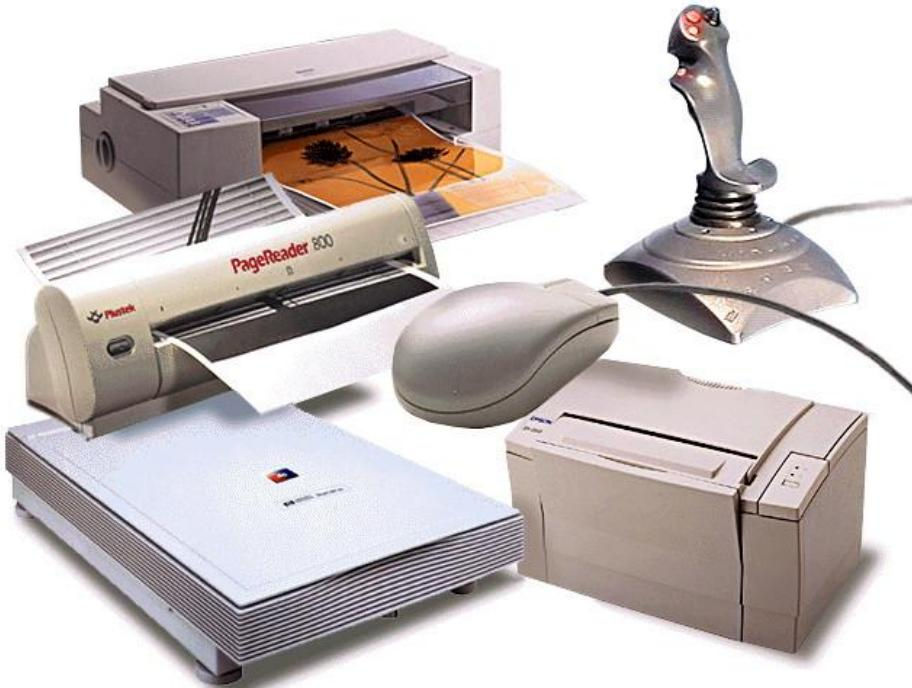
□ **Устройства вывода** — периферийные устройства, преобразующие результаты обработки цифровых машинных кодов в форму, удобную для восприятия человеком или пригодную для воздействия на исполнительные органы объекта управления.
