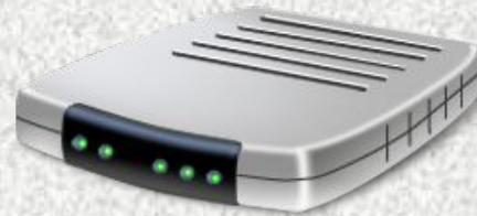
По конструктивному исполнению модемы делятся на **внутренние** и **внешние**. Внутренние модемы выполняются в виде карты расширения, вставляемой в свободный слот компьютера. На внешней стороне карты модема находятся гнезда для подключения кабеля телефонной линии. Внешний модем гораздо проще в установке: его подключают к РС- разъему последовательного порта.
