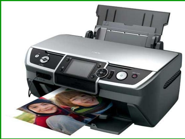
Печатающее устройство, предназначенное для вывода текстовой и графической информации на бумагу, пленку. Одни принтеры позволяют печатать только в одном цвете, другие – выводить многоцветные изображения.
