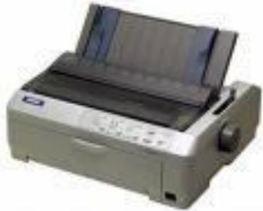
Печатающая головка матричного принтера состоит из вертикального столбца маленьких стержней (в количестве 9 или 24), которые под воздействием магнитного поля выталкиваются из головки и ударяют по бумаге через красящую ленту. Перемещаясь, печатающая головка оставляет на бумаге строку символов.
