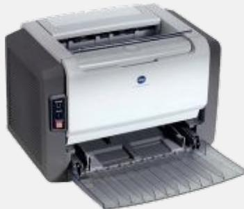
**Лазерный принтер** создаёт намагниченную область, к которой притягивается печатающий порошок (тонер), затем лист бумаги попадает в “печь”, где порошок плавится, после чего порошок охлаждается и затвердевает, в результате чего на листке появляется готовое изображение.
