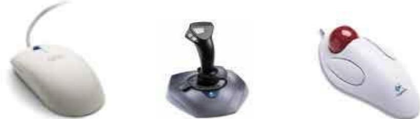
Для ввода графической информации и для работы с графическим интерфейсом программ используются координатные устройства ввода информации
