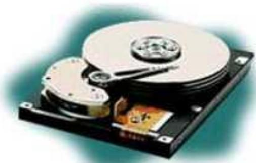
Предназначен для постоянного хранения той информации, которая более или менее часто используется в работе: программ операционной системы, компиляторов языков программирования, сервисных (обслуживающих) программ, прикладных программ пользователя, текстовых документов, файлов базы данных и т.д.
