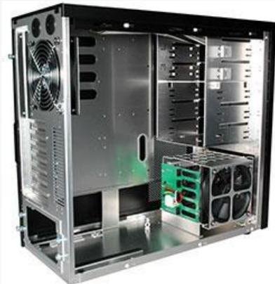
*Корпус* физически представляет собой шасси, которое наполнено аппаратным обеспечением для создания компьютера.
