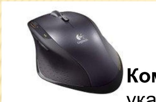
**Компьютерная мышь** это указательное устройство ввода. Mouse перемещается на экране вашего монитора и передает эту информацию компьютеру. На экране это устройство отражается в виде специального курсора.
