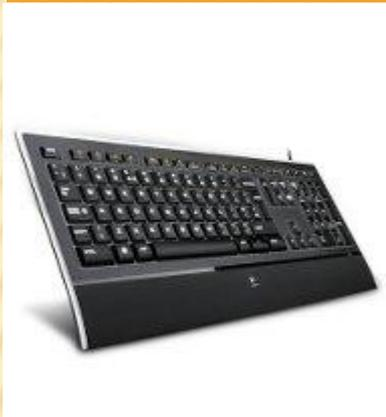
Клавиатура компьютера — устройство для ввода информации в компьютер и подачи управляющих сигналов. Содержит стандартный набор клавиш печатной машинки и некоторые дополнительные клавиши — управляющие и функциональные клавиши, клавиши управления курсором и малую цифровую клавиатуру.
