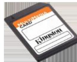
**Flash-память** – это энергонезависимый тип памяти, позволяющий записывать и хранить информацию на микросхемах. Flash-память обеспечивает высокую сохранность данных, высокую скорость записи и считывания информации при небольших размерах. Устройства на основе flash-памяти не имеют в своём составе движущихся частей, что обеспечивает высокую сохранность данных при их использовании в мобильных устройствах
