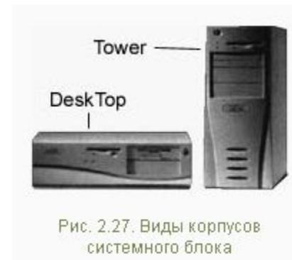
Рис. 2.27. Виды корпусов системного блока
