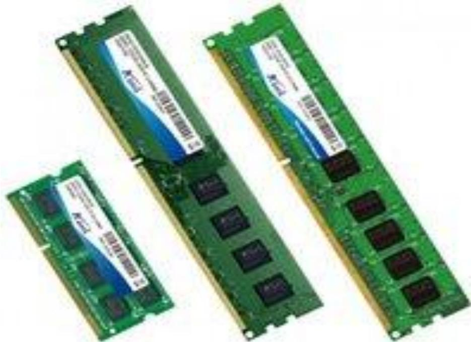
Модули оперативной памяти могут быть различных типов: DDR, DDR2 и другие.
