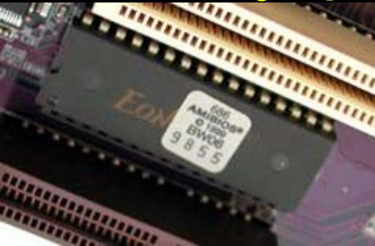
**ПЗУ (постоянное запоминающее устройство)** - память, предназначенная для хранения микропрограмм, которые используются при включении компьютера (когда оперативная память ещё не задействована) для тестирования его компонентов.
