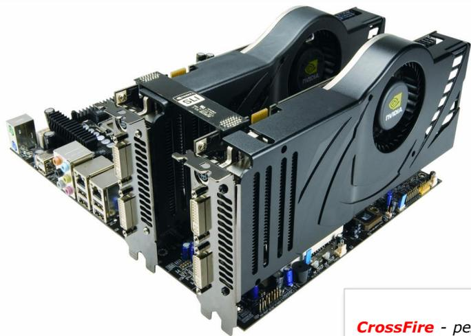
**SLI** - разработка компании «**NVIDIA**», позволяющая объединить усилия сразу нескольких устройств этой фирмы с целью повышения производительности работы системы. **Scalable Link Interface** (именно так расшифровывается SLI) достаточно требовательна к техническому обеспечению: материнская плата SLI с чипсетом NVIDIA (необходимо наличие двух и более портов PCI-Express), мощный и надежный блок питания, видеокарты GeForce с шиной PCI-Express и чипсетом одного семейства, соединитель (мост).
