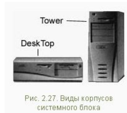
Рис. 2.27. Виды корпусов системного блока
