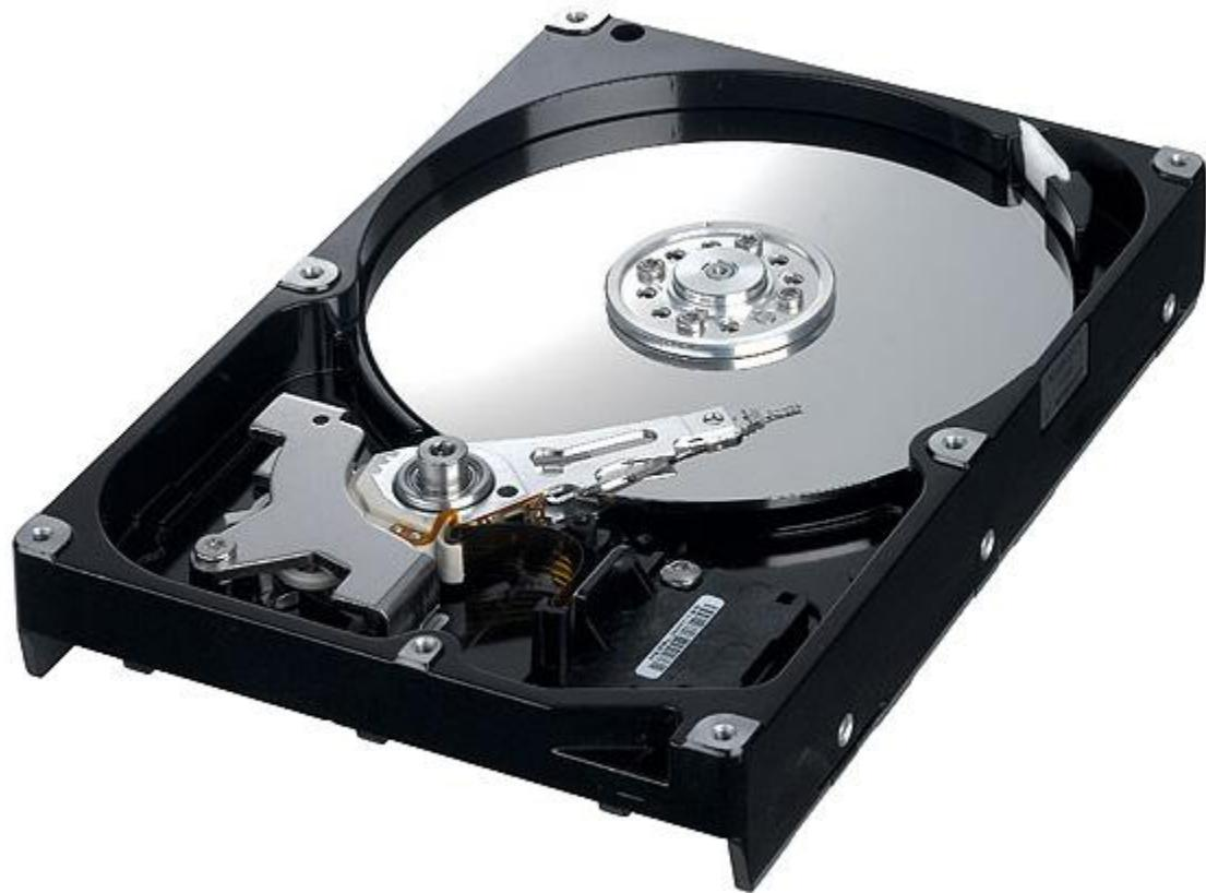
**Накопитель на жёстких магнитных дисках** или **жёсткий диск** («винчестер») — запоминающее устройство произвольного доступа, основанное на принципе магнитной записи. Является основным накопителем данных в большинстве компьютеров.
