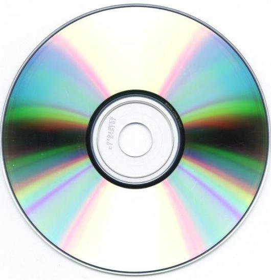
*CD-ROM – доработанная версия CD-DA (диска для хранения аудиозаписей), позволяющая хранить на нём прочие цифровые данные. Позже были разработаны версии с возможностью как однократной записи (CD-R), так и многократной перезаписи (CD-RW) информации на диске.*
