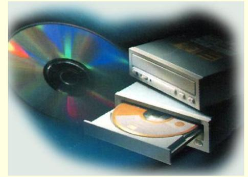
**CD-ROM** – это оптический носитель информации, предназначенный только для чтения.
