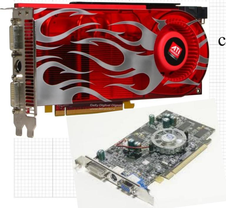
Современные видеоадAPTERы имеют собственный вычислительный процессор (видеопроцессор), который снижает нагрузку на основной процессор при построении сложных изображений.
