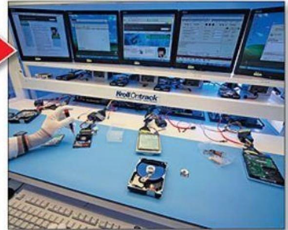
После этого вся информация, которую можно считать, переносится с магнитных пластин поврежденного жесткого диска и сохраняется на ПК лаборатории
