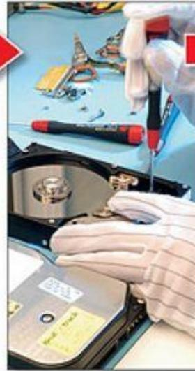
При отсутствии дефектов в электронике магнитные пластины жесткого диска устанавливаются в другой корпус. Эта операция выполняется в максимально чистом помещении для предотвращения попадания пыли в накопитель
