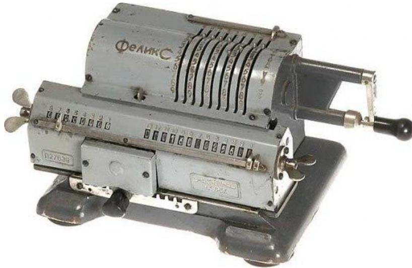
**Арифмометр** — настольная (или портативная) механическая вычислительная машина, предназначенная для точного умножения и деления, а также для сложения и вычитания. была предложена в 1670 году немецким ученым Г. В. Лейбницем.
