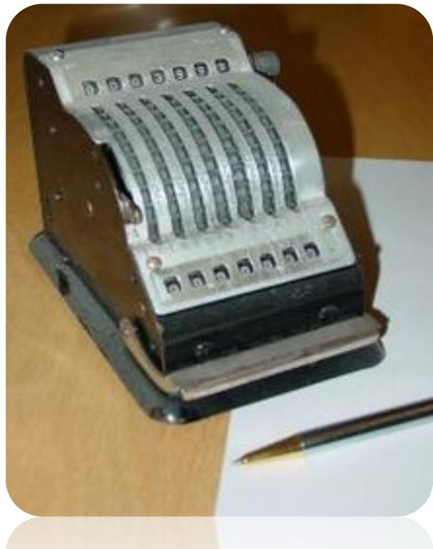
**Вычислительная машина**, — устройство, — устройство, предназначенное для автоматического выполнения математических, — устройство, предназначенное для автоматического выполнения математических операций.
