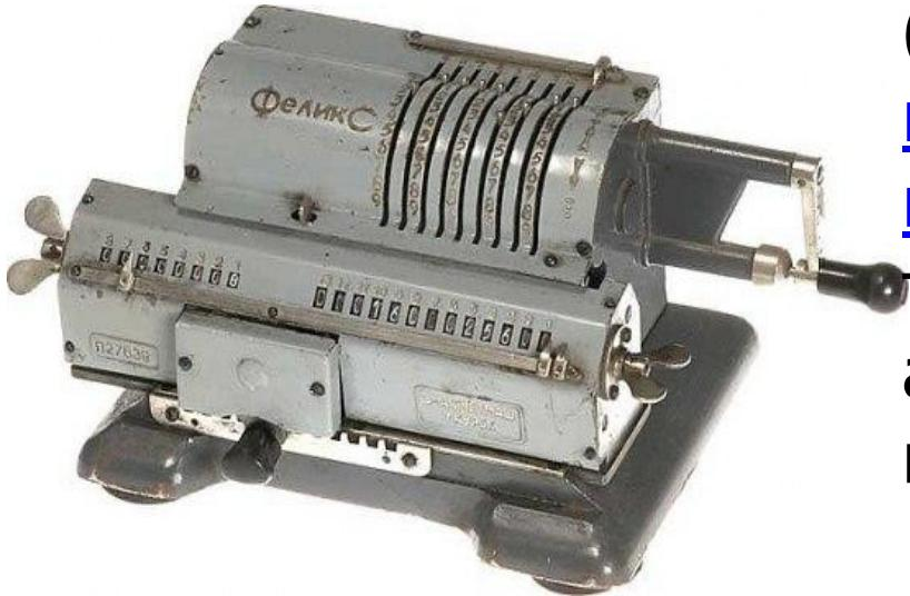
**Арифмометр** — настольная (или портативная) механическая вычислительная машина, предназначенная для точного умножения и деления, а также для сложения и вычитания. была предложена в 1670 году немецким ученым Г. В. Лейбницем.
