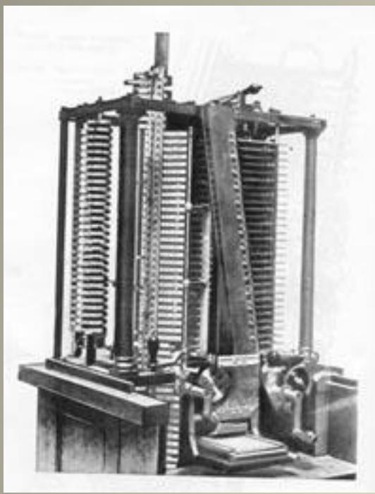
1830-1846 гг. Чарльз Бэббидж разрабатывает проект Аналитической машины - механической универсальной цифровой вычислительной машины с программным управлением (!). Машина состоит из пяти устройств - арифметического устройства (AY), запоминающего устройства (ЗУ), устройства управления (УУ), ввода и вывода (все как в первых ЭВМ, появившихся 100 лет спустя). АУ строилось на основе зубчатых колес. Для ввода программы и данных использовались перфокарты.
