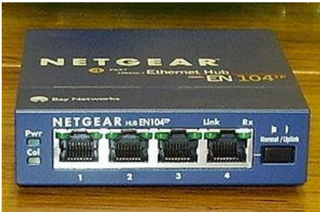
**Сетевой концентратор или хаб** — сетевое устройство, предназначенное для объединения нескольких устройств Ethernet в общий сегмент сети.
