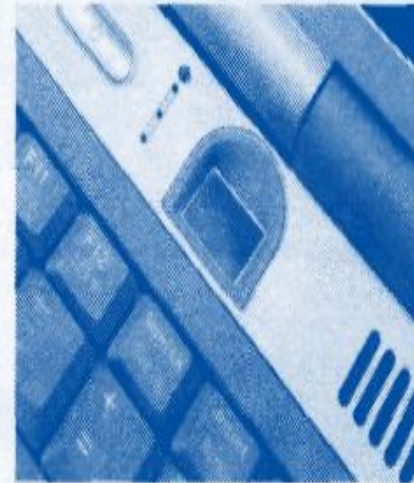
. Оптический сканер отпечатка пальца, вмонтированный в ноутбук
