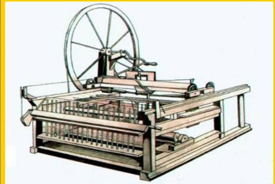
Рост заморской торговли способствовал развитию мануфактурного производства. В 1765 г. Дж. Харгривс, борясь с конкуренцией дешевых индийских тканей, соорудил механическую прялку. Производительность труда выросла в 20 раз.
