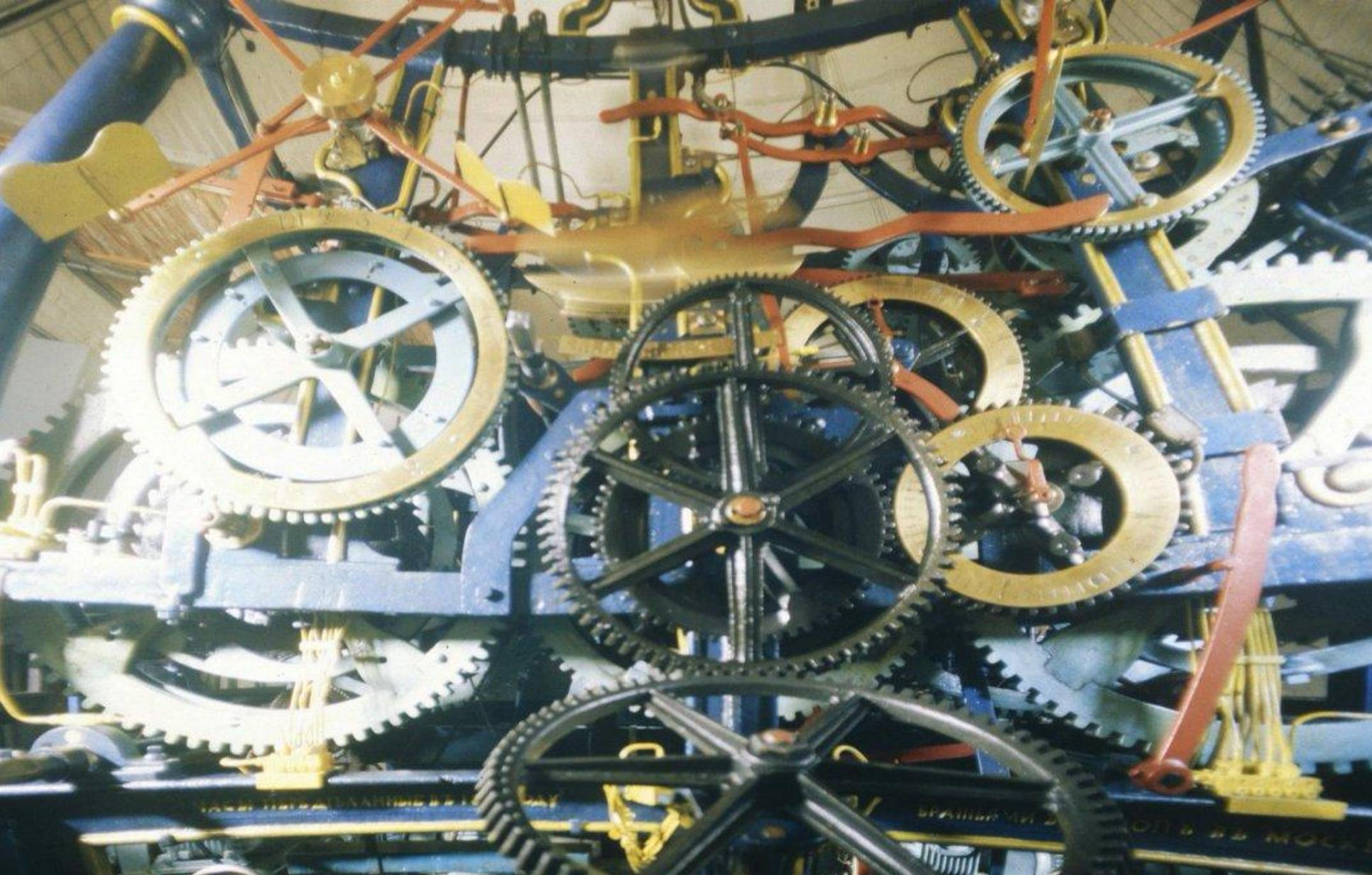
Часы занимают специальные этажи на Спасской башне: с 8-го по 10-й. Их основной механизм находится в специальной комнате на 9 этаже. Его приводят в действие три гири весом примерно от 160 до 224 кг.
