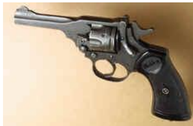
Рис. 118. Общий вид пистолета Вебли-Скотта калибра 450. 1 — ствол; 2 — замок-болт; 3 — рамка; 4 — курок; 5 — магазинный предохранитель; 6 — предохранительная скоба; 7 — курковый крючок
