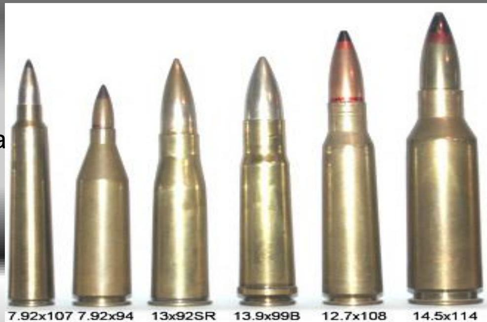
Мощный патрон Б-32 калибра 14.5x114 мм имел прекрасные на то время характеристики. Бронебойно-зажигательная пуля с каленым сердечником и пиротехническим составом покидала ствол со скоростью 1100 м/с и пробивала 20мм брони, под углом 70 градусов, на расстоянии в 300м.
