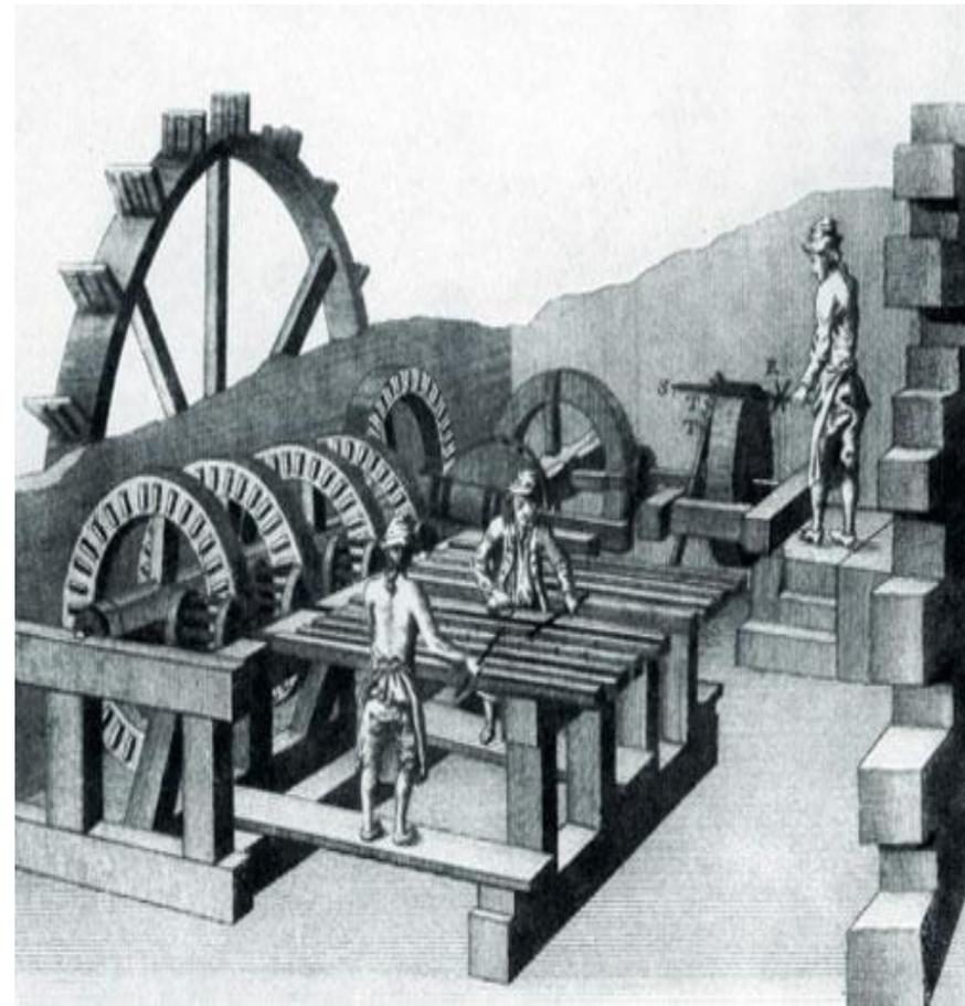
**Полировка каналов и наружных поверхностей стволов в оружейной мануфактуре XVIII века.**
