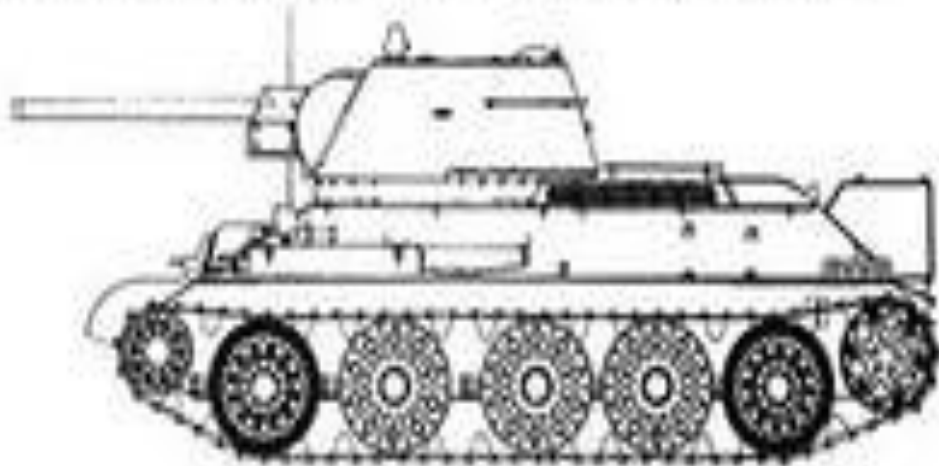
Средний танк Т-34 образца 1943 года с «уголовой» башней (выпуск конца 1942 года)
