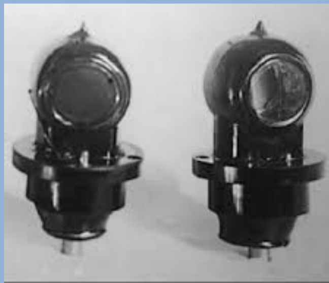
Электронно-оптические преобразователи Ц-1 и Ц-2 (1942 г.).
