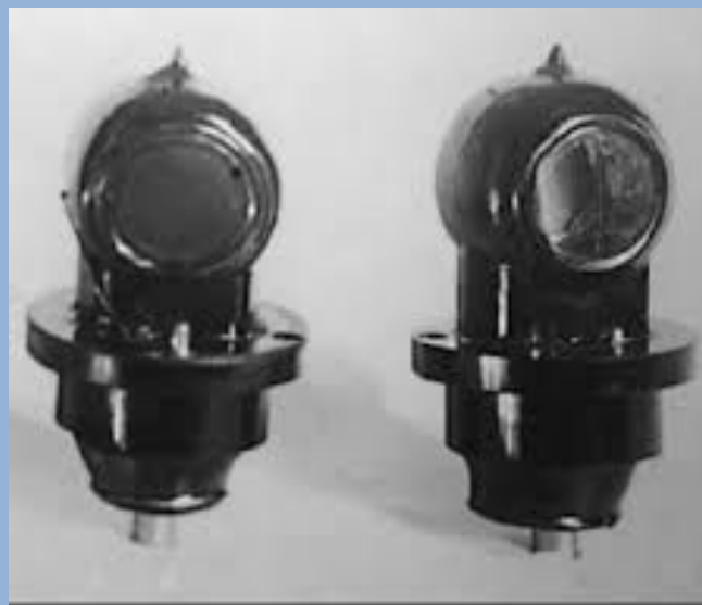
Электронно-оптические преобразователи Ц-1 и Ц-2 (1942 г.).
