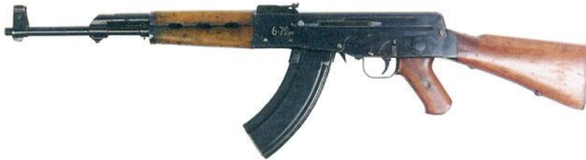
Перший дослідний автомат Калашникова під патрон 7,62мм, 1946 рік. Також відомий, як АК-46 .
