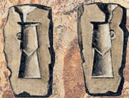
Форма для отливки топора
