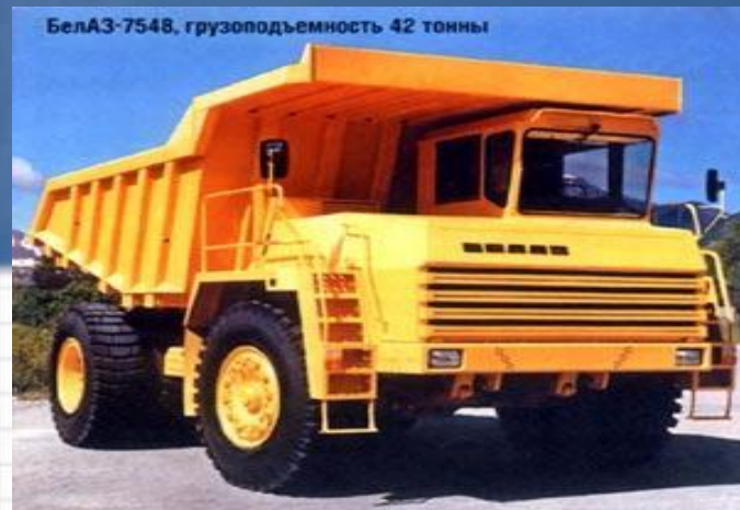
БелАЗ-7548, грузоподъемность 42 тонны
