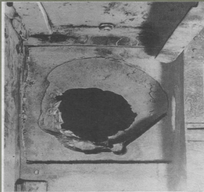
Пробоина в броне каземата 152-мм орудия линейного корабля «Евстафий» (из фондов РГАВМФ, публикуется впервые)
