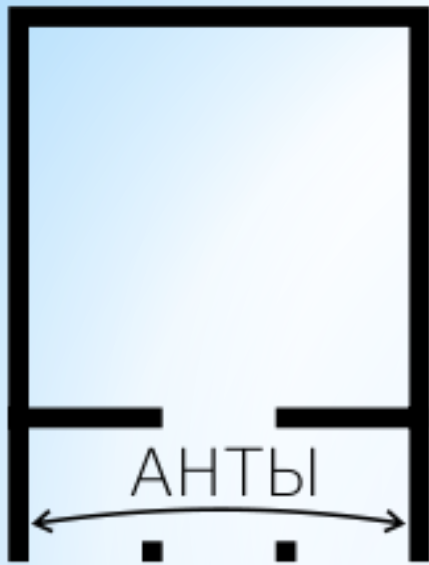
Схема древнегреческого храма типа мегарон
